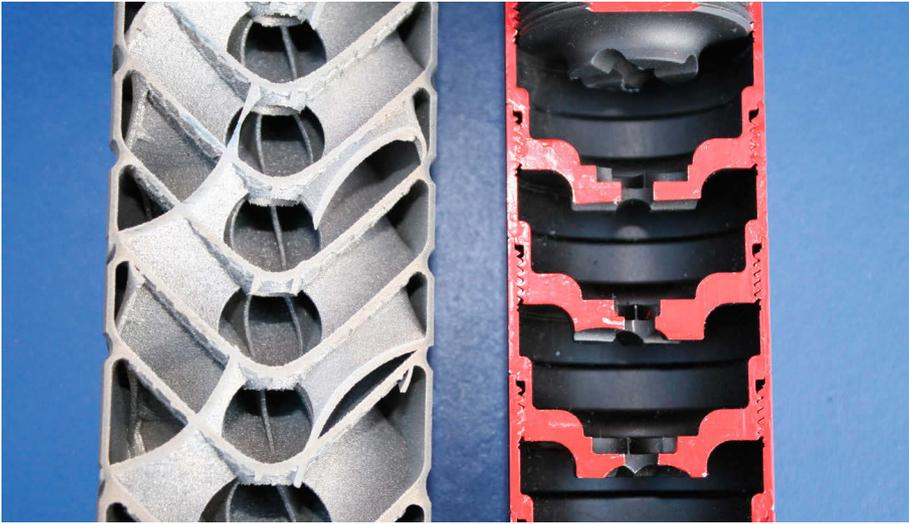
**Aufschneider (von links):** Schnitt durch zwei Dämpfer aus dem Hause Roedale. Das Modell aus Titanlegierung aus dem 3D-Drucker kommt im Vergleich zur herkömmlichen Herstellung ohne Schrauben oder Schweißen aus. Das vermeidet doppelte Wandstärken bei besserer Stabilität.
