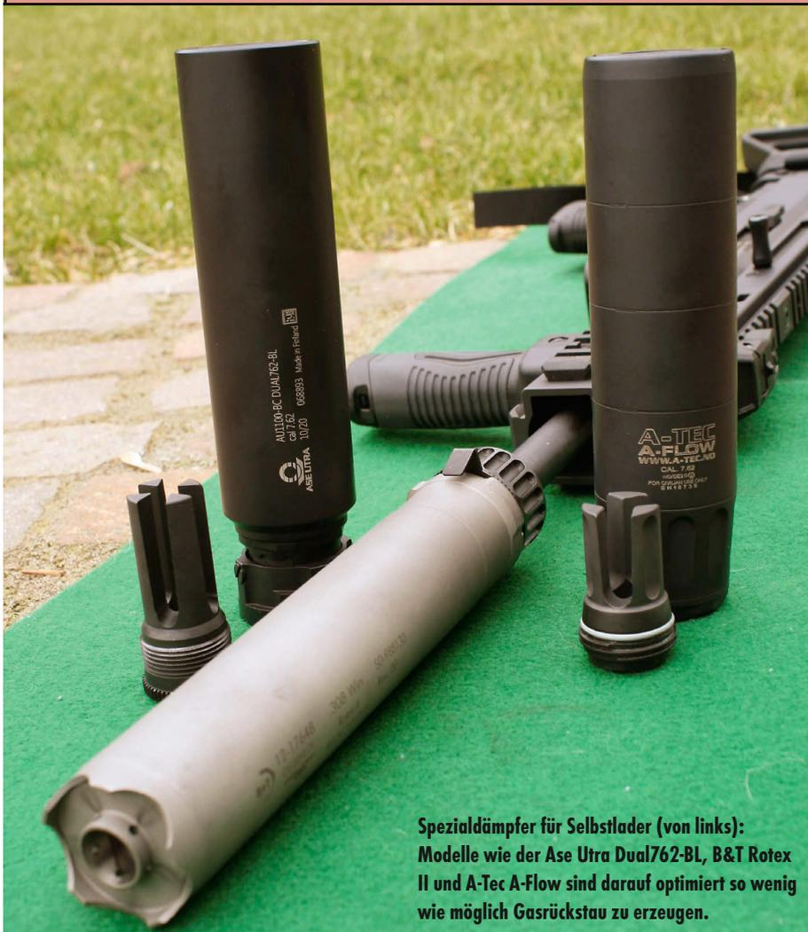
**Spezialdämpfer für Selbstlader (von links): Modelle wie der Ase Utra Dual762-BL, B&T Rotex II und A-Tec A-Flow sind darauf optimiert so wenig wie möglich Gasrückstau zu erzeugen.**
