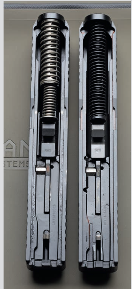
Glock ist wieder zur einfachen Federführungsstange mit der hochkant gewickelten Flachdrahtfeder wie bis zur Generation 3 zurückgekehrt.
