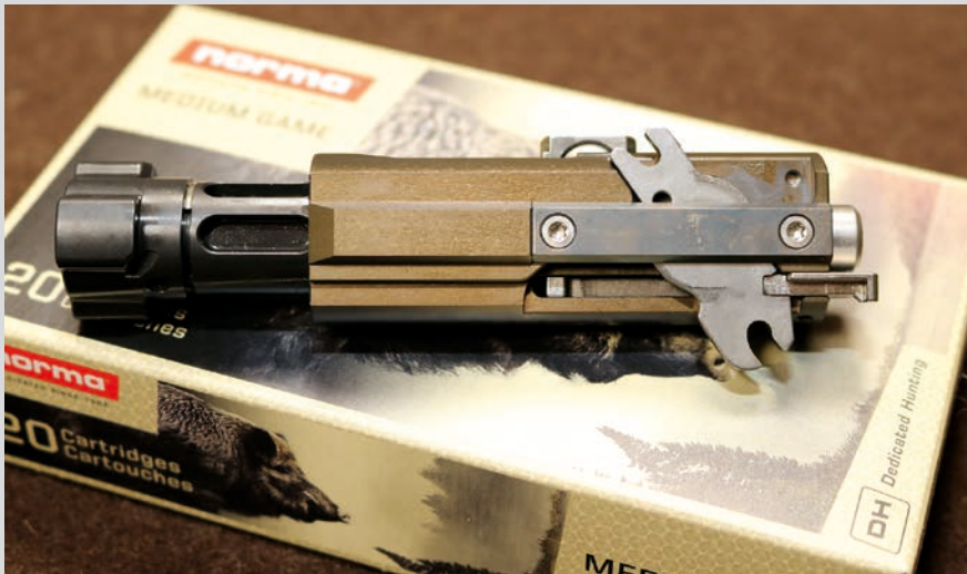
Die Verschlussunterseite trägt ein bewegliches Teil, welches mit dem Kammerstängel verbunden ist. Zum Ausbau des Verschlusses muss der Kammerstängel zunächst vom Verschluss entkoppelt werden.
