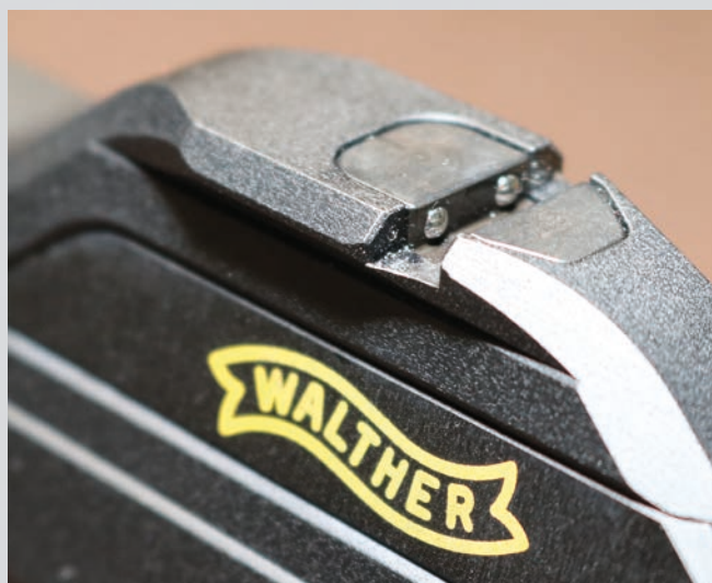
Die vordere Montagebasis ist mit zwei federbelasteten Kugeln ausgestattet. Die drücken auf den Querstollen der Montage und garantieren somit eine wiederholholgenaue Montage der Optik.
