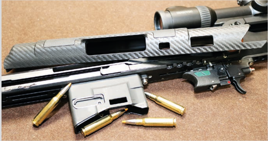
Im ausgebauten Zustand ist die Handspannereinheit gut zu sehen. Darüber der Schaft Rücken aus Kunststoff mit Kohlefaseroptik.
