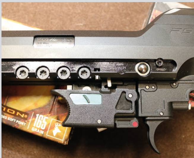
Die vier horizontal angeordneten Schrauben übernehmen die Laufklemmung. Die Kugel rechts daneben arretiert den Kammerstängel in der vorderen Position.
