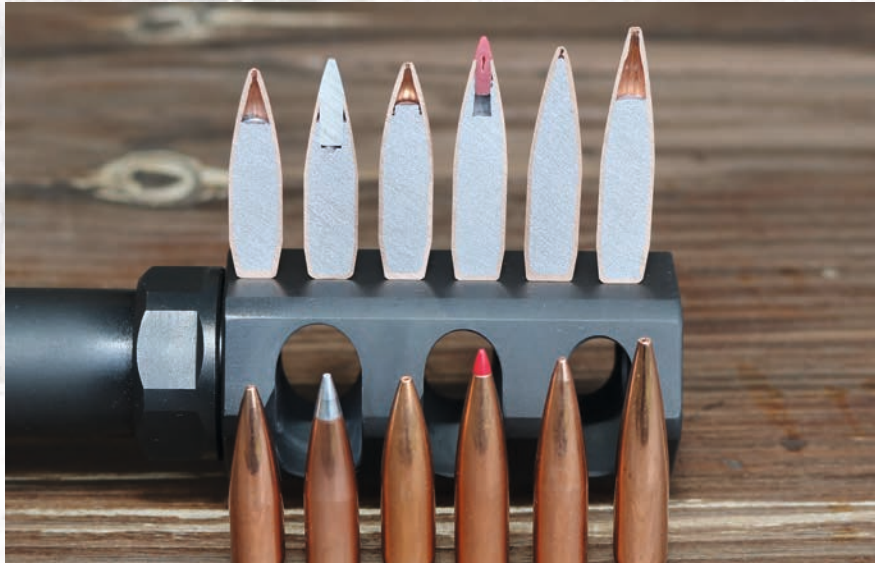
Die für die Handladungen verwendeten Geschosse im Schnitt und von außen (v.l.): 175 gr Lapua MaxRT, 176 gr Hornady A-Tip, 190 gr Sierra MatchKing, 208 gr Hornady ELD-M, 210 gr Sierra Matchking und 215 gr Berger Hybrid Target.
