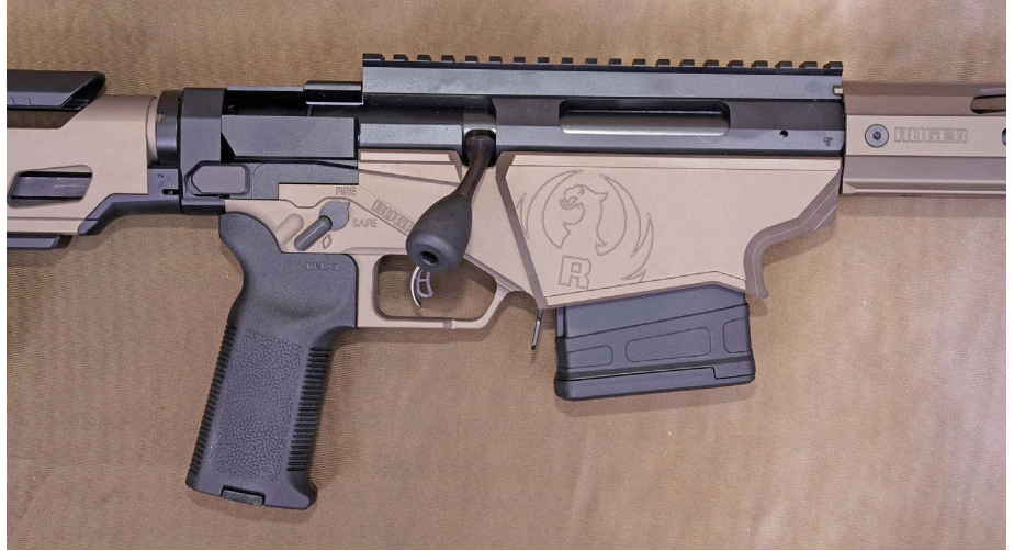
Das Leichtmetallgriffstück mit beidseitiger 45-Grad-Sicherung, die als Daumenauflage genutzt werden kann, sowie dem freistehenden Magpul MOE K2-Pistolengriff, der nahezu vertikal angeordnet ist.
