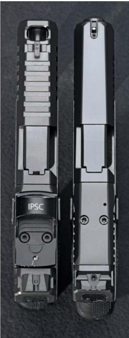
Die kompensierte Version der P-10 C besitzt die gleichen Außenabmessungen wie die Standardversion. Die Greifrillen im vorderen Verschlussbereich finden sich auch auf der Oberseite wieder, was die Handhabung verbessert.
