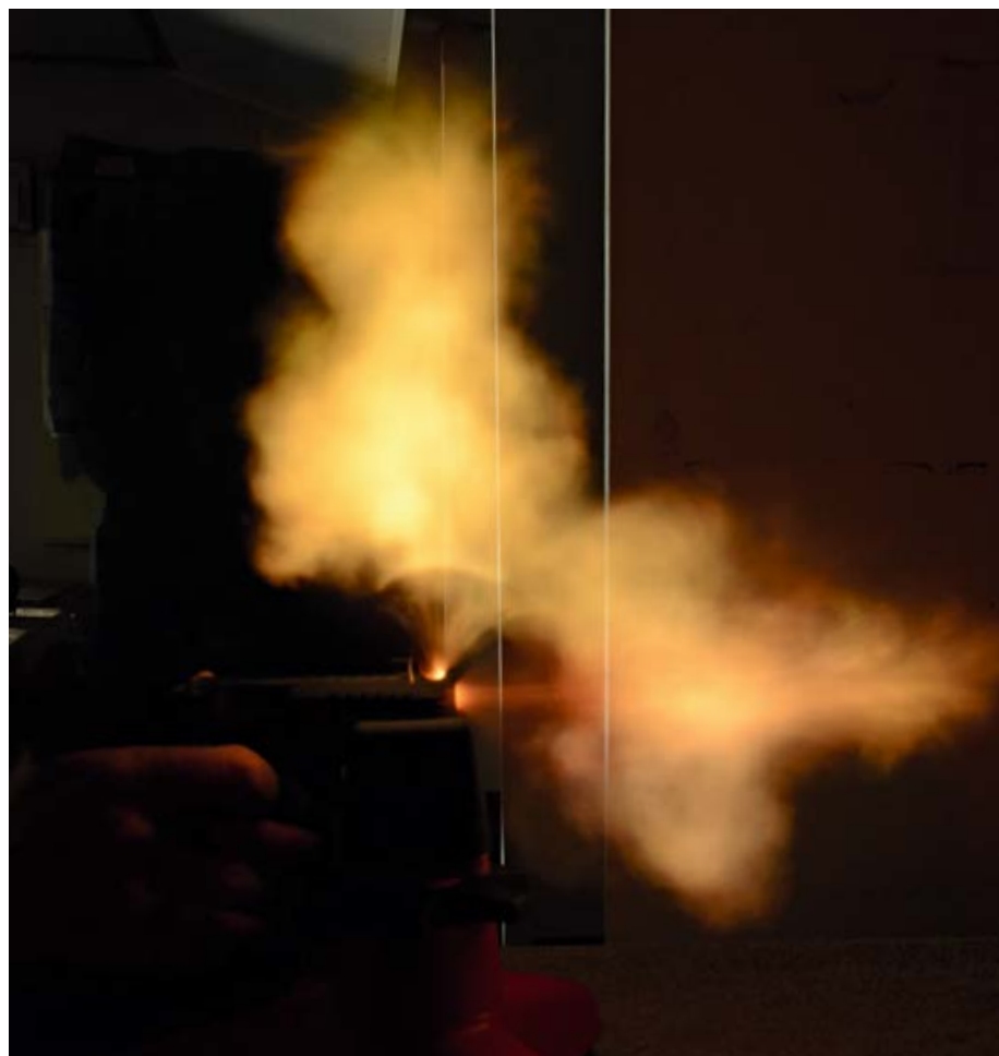
Bei der Magtech 95 Grains kann man gut erkennen, wieviel Mündungsfeuer am Kompensator nach oben abgeblasen wird.
