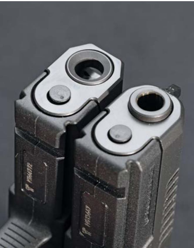
Der dickere Lauf (links) der kompensierten Ausführung ist etwas zurückgesetzt und angetrichert, was zum eigenständigen Erscheinungsbild im Vergleich zur P-10 C Standard (rechts) beiträgt.
