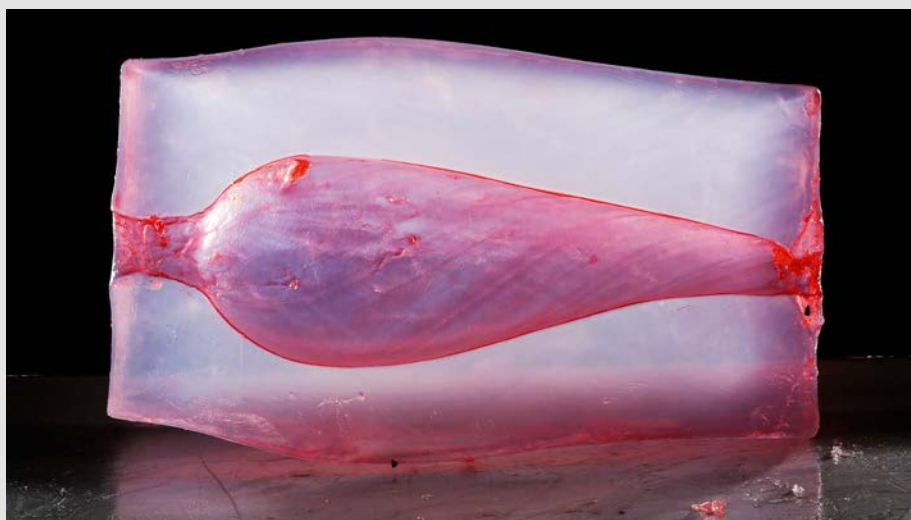
Welche zielballistische Wirkung in der .460 S&W Mag. steckt, zeigt eindrucksvoll dieser Seifenblock. Das expandierende 275 Grains Barnes-Vollkupfergeschoss dringt bis in den nachfolgenden Block auf 40 cm Gesamttiefe ein. Mit rund 780 cm 3 Kavernenvolumen entspricht das etwa einer Flasche Wein.
