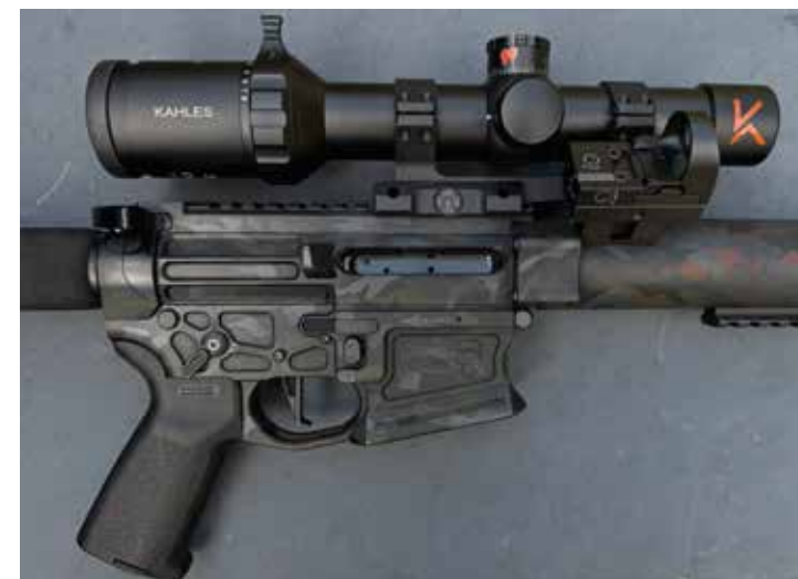
Das 640 Gramm schwere LPVO-Zielfernrohr in 1-8x24 mit 34-mm-Mittelrohr besticht durch die Summe seiner technischen Eigenschaften und offeriert ein riesiges Sehfeld von 50 m auf 100 m bei 1-facher Vergrößerung.
