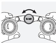
通过旋转聚焦轮，可以从最短的调整距离（见技术数据表）到无限大，将每一个物体聚焦。
