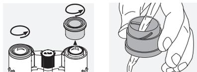
Bei starker Verschmutzung (z.B. Sand) sind die Drehaugenmuscheln komplett abschraubbar und somit sehr einfach zu reinigen.
