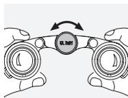
En faisant tourner la molette de focalisation, vous pouvez faire la mise au point sur chaque objet, de la distance minimum de la mise au point (voir la fiche signalétique technique) à l'infini.
