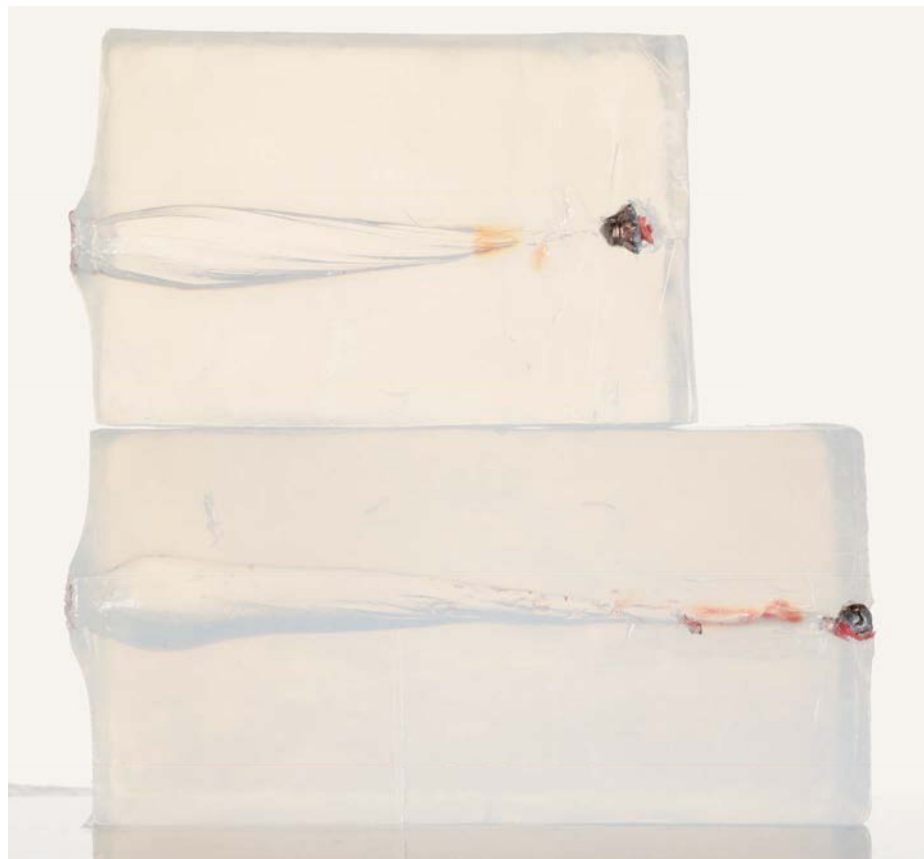
Saubere Sache – zielballistische Untersuchungen in Seife: Oben der permanente Schusskanal der .45 Auto mit der Hornady 220 Grains Critical Duty. Das Geschoss erreicht 22 cm Eindringtiefe und pilzte dabei auf rund 19 mm auf. Gut zu erkennen, die Spiralen, die das rotierende Projektil in der Seife hinterlassen hat. Die 10 mm Auto (unten) erreicht mit dem 175 Grains Critical Duty eine Eindringtiefe von 30 cm und kam erst auf dem letzten Zentimeter zum Stehen. Das Geschoss pilzte dabei auf rund 13 mm auf.
