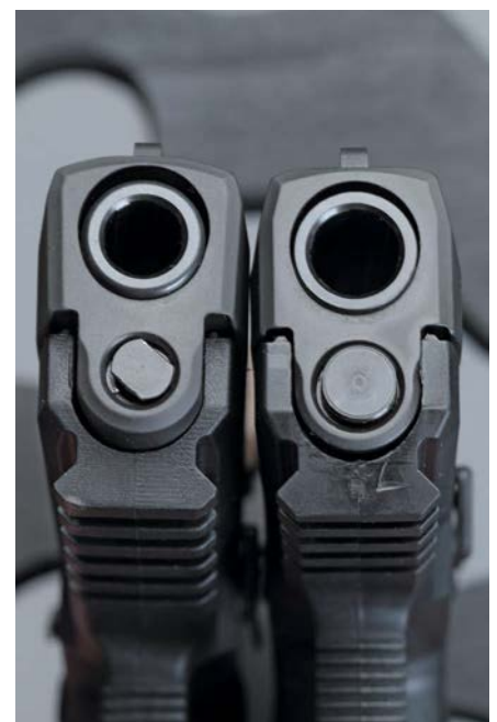
Die tief abkippenden Läufe verlangen nach einer leicht ovalen Bohrung im Verschluss.
