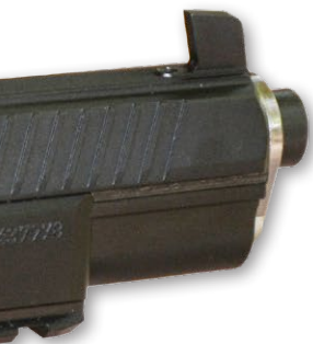
LAUF DER TAIPAN , das Absteuerungsstück mit Zufuhrampe. Auf dem Lauf befinden sich die beiden Kämme zur Verriegelung.
