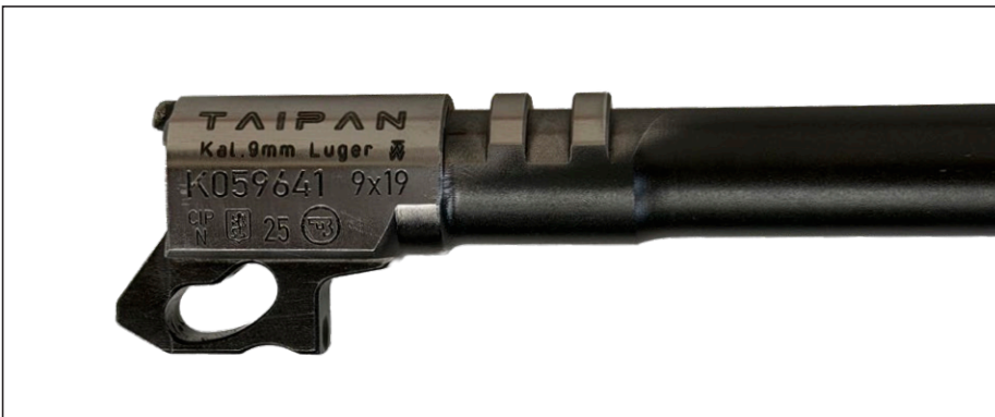
LAUF DER TAIPAN , das Absteuerungsstück mit Zufuhrampe. Auf dem Lauf befinden sich die beiden Kämme zur Verriegelung.
