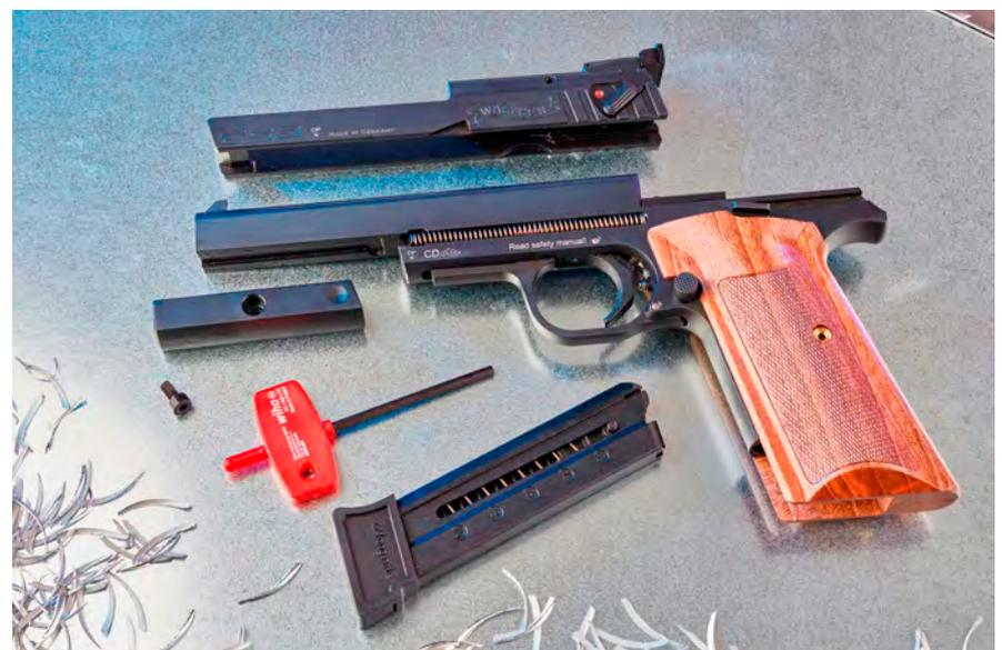
Zur Demontage wird das Vordergewicht entfernt, dann (wie bei der Walther PPK) der Abzugsbügel heruntergezogen. Dann kann man den Verschluss abnehmen.
