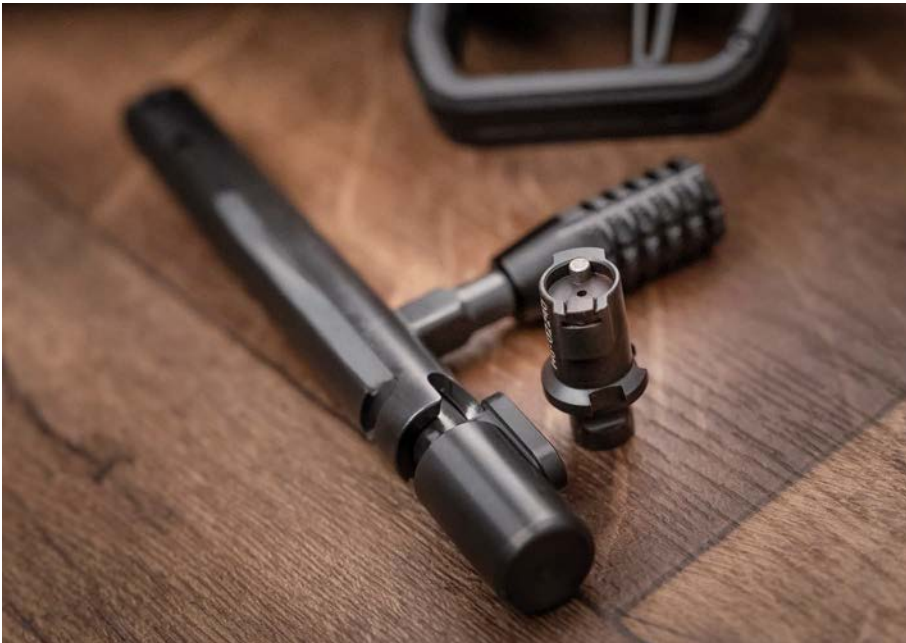
Der Verschluss mit zwei Verriegelungswarzen und T-förmigem Auszieher im Detail.
