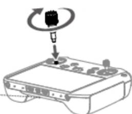
Die Steuerknüppel montieren und sie zur Sicherung festdrehen.
