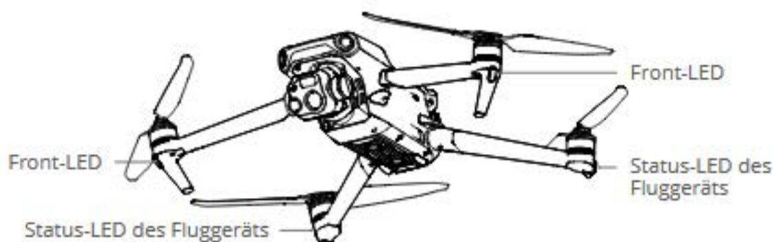
Wenn das Fluggerät eingeschaltet ist, aber die Motoren nicht laufen, dann leuchten die Front-LEDs durchgehend rot, um die Ausrichtung des Fluggeräts anzuzeigen.
