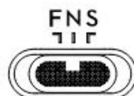
Der Funktionsmodus kann in DJI Pilot 2 auf T-Modus (Stativmodus) oder A-Modus (Fluglagemodus) eingestellt werden.
