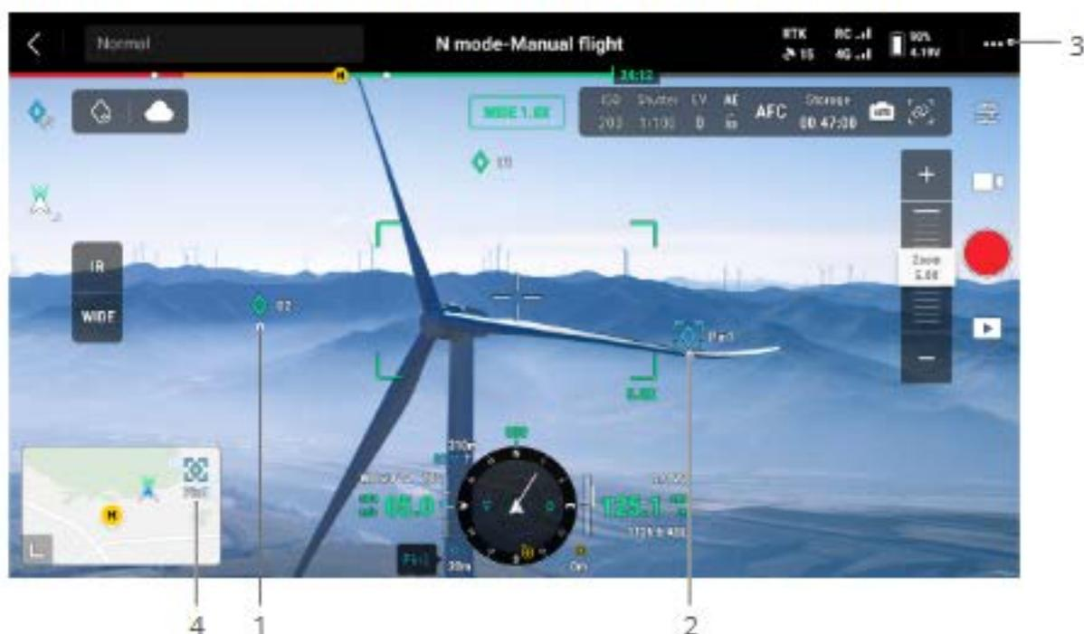
1. Die AR-Projektion wird für den PinPoint in der Kameraansicht erstellt. Die Größe des PinPoints wird entsprechend der Distanz zwischen dem Fluggerät und dem PinPoint angepasst (groß, wenn nah, klein, wenn fern).
