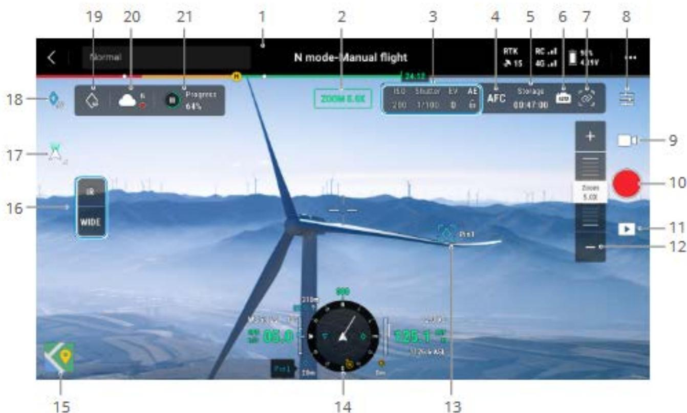
1. Obere Leiste: zeigt den Status des Fluggeräts, den Flugmodus, die Signalstärke usw. an. Weitere Einzelheiten finden Sie im Abschnitt „Obere Leiste“.
