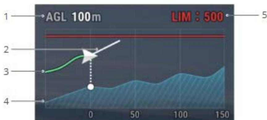
1. Flughöhe über Boden (AGL): Zeigt die Flughöhe des Fluggeräts relativ zum Boden darunter an.
