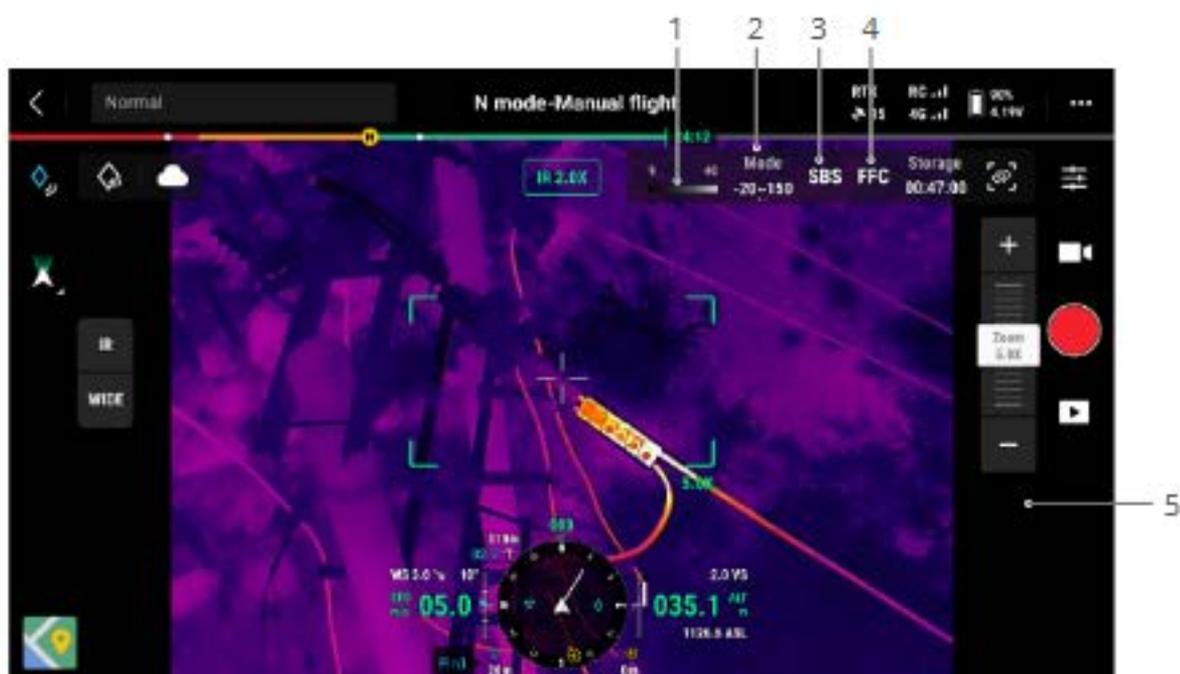
1. **Palette:** zeigt die höchsten und niedrigsten Temperaturmesswerte der aktuellen Ansicht an. Antippen, um zwischen verschiedenen Infrarot-Messpaletten zu wählen oder die Isotherme zu aktivieren, um Temperaturmessintervalle zu konfigurieren. Hinweis: Wenn der gemessene Bereich die maximalen oder minimalen Temperaturmesswerte der aktuellen Ansicht überschreitet, hat die Einstellung keine Auswirkungen.
