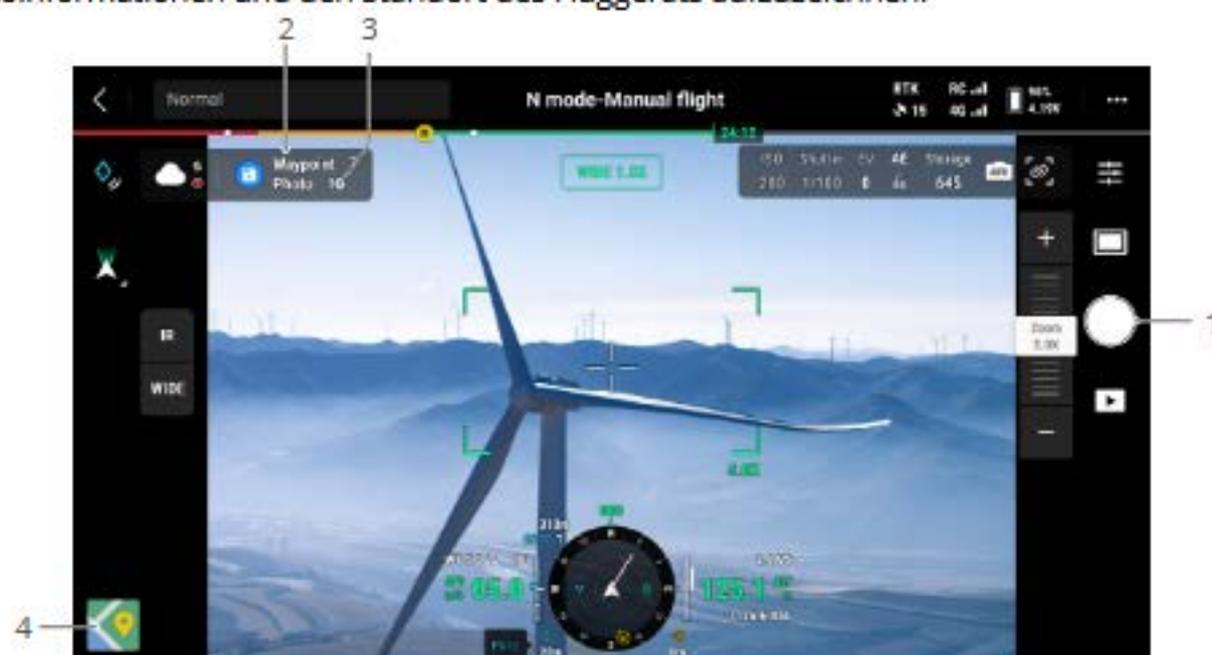
1. Steuern Sie den Gimbal, stellen Sie die Zoom-Skala ein und positionieren Sie das Motiv in die Bildmitte. Antippen, um Fotos aufzunehmen oder drücken Sie die Taste C1 der Fernsteuerung, um einen Wegpunkt hinzuzufügen. Die Anzahl der Wegpunkte und Fotos wird entsprechend hinzugefügt.
