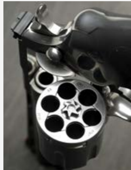
Ein Blick auf den dreieckigen Ausstoßer mit seinem stark erhabenen Trommelstern.
