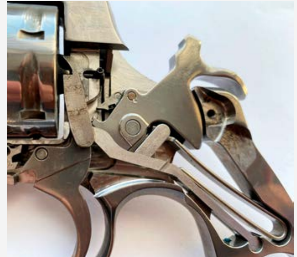
Die Energie für Hammer- und Trommeltransporter-Antrieb beziehen beide Modelle aus einer zweiseitigen Blattfeder.
