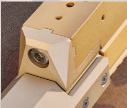
Der verzahnt montierte Block verbindet Systemträger und Handschutz. Die 5 Schrauben sind verklebt. Zugunsten der Präzision soll dies die vom Werk eingestellte Passgenauigkeit der Bauteile sichern.
