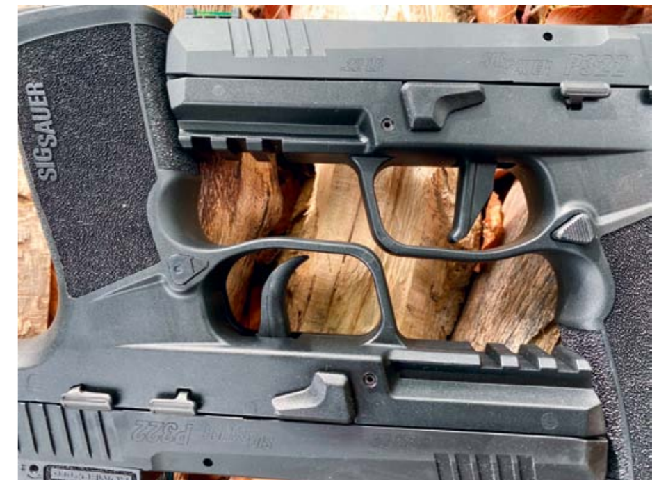
Ein leicht zu montierender Abzugsschuh verwandelt die gekrümmte Zunge in einen geraden Abzug.
