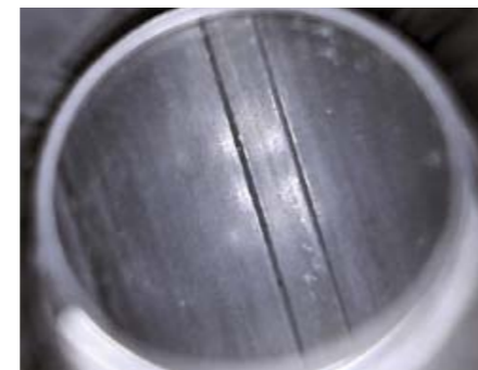
Nach 500 Schuss ohne Zwischenreinigung sah unser P322-Lauf bei der Betrachtung mit dem Endoskop noch sehr ordentlich aus.
