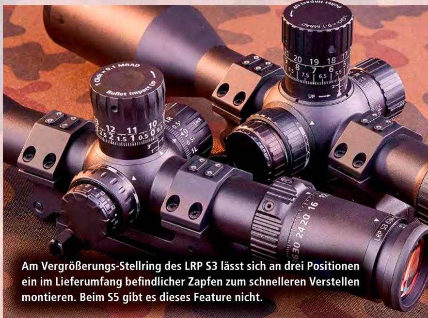
Am Vergrößerungs-Stellung des LRP S3 lässt sich an drei Positionen ein im Lieferumfang befindlicher Zapfen zum schnelleren Verstellen montieren. Beim S5 gibt es dieses Feature nicht.
