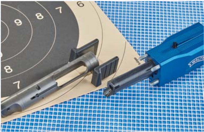
Der KK-Verschluss samt Spannköpfen (die Feder verbirgt sich darunter) und der Laufblock, durch vier Schrauben befestigt.
