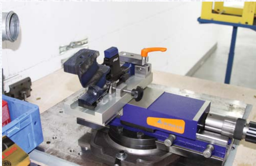
Auf der 25-m-Bahn wurden die Pistolen kopfüber eingespannt und per Laser ausgerichtet. Rechts oben der Rahmen des Geschwindigkeitsmessgeräts.
