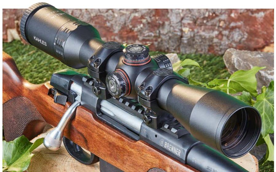
Dank abgeschraubter Abdeckkappen erkennt man hier die gut lesbare Skala für die Klickverstellung, die das Absehen pro Klick um 1 cm auf 100 m Entfernung korrigiert.
