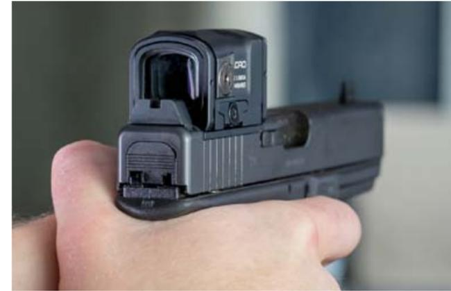
Glock G17 Gen4 MOS mit Aimpoint Acro P-2. Mit der montierten Ameriglo-Schalldämpfervisierung wird ein „Lower 1/3 Co-Witness“ erreicht, die mechanische Visierung ist also im unteren Drittel der Linse zu sehen.
