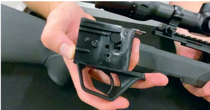
Das leicht demontierbare Abzugsmodul der Beretta ermöglicht, den Abzug in drei Gewichtsklassen einzustellen.
