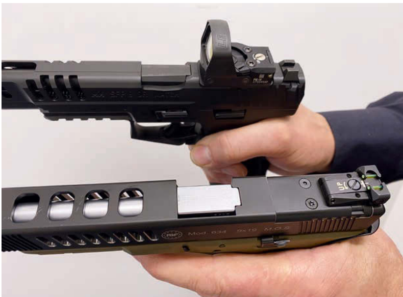
Nicht für jede Optik ready: Die Adapterplatten bilden eine Stufe im Verschluss. Sie limitieren die Länge des Rotpunktvisiers auf rund 49 Millimeter.
