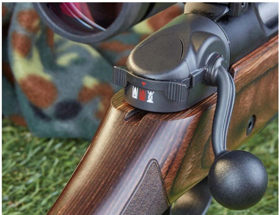
**Der Kammergriff wird zum Spannen der Jaeger NXT ganz nach vorn gedrückt. Die Wippe hinten bietet drei Positionen zum Sperren und Entriegeln des Verschlusses.**
