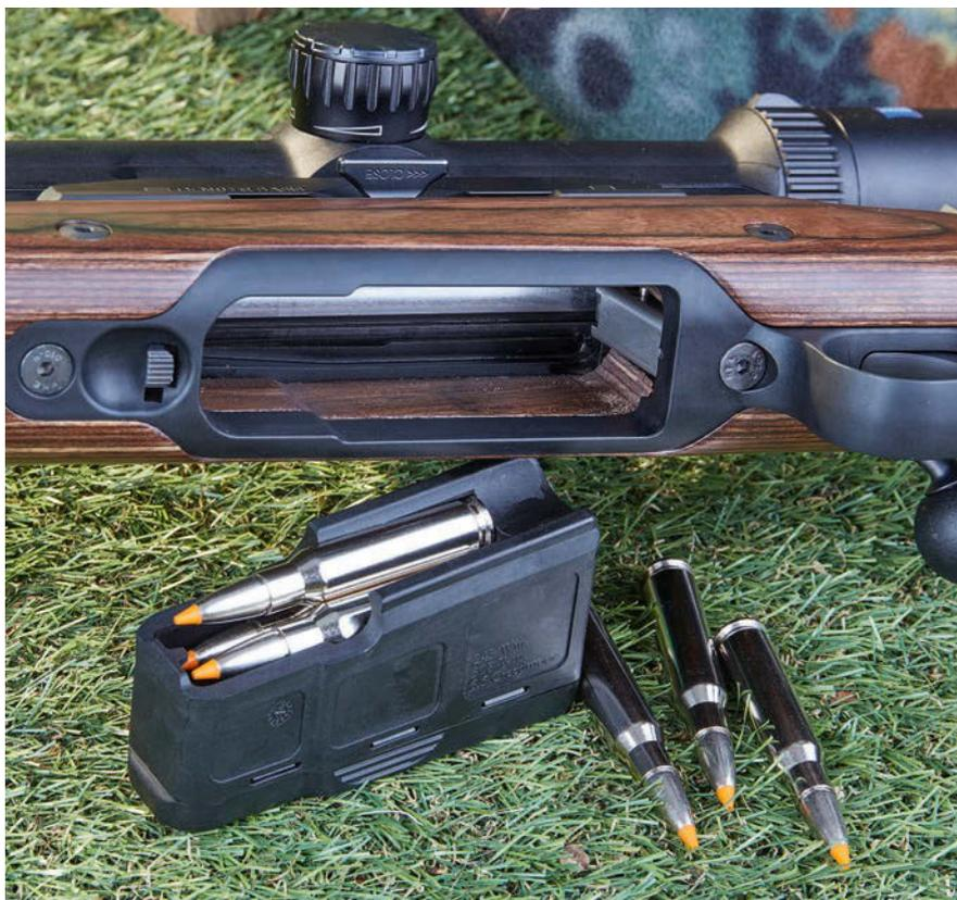
**Verschiebt man die kleine Taste vor dem Magazinschacht seitlich, wird das Magazin in der Waffe festgesetzt, so geht nichts mehr verloren.**
