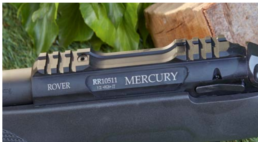
Fest integriert: Die zweiteilige Picatinny-Schiene der Mercury Rover Hunter G2 erweist sich als aus dem Vollen gearbeitet. Unten links hinten sitzt der Kammerhalter.
