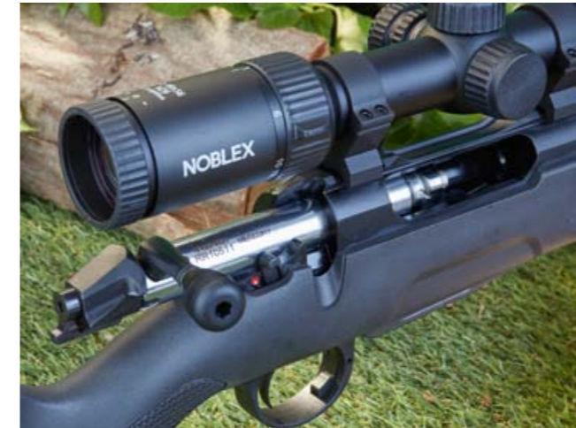
Rechts neben dem Verschluss sieht man den Kipphebel der hier auf Feuerbereit stehenden Sicherung. Wie das Foto zeigt, kommen die Finger zum Bedienen gut unter dem Glas vorbei.
