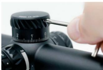
2. Ziehen Sie die Turmkappe nach oben ab. Darunter befindet sich der Zero Click Stop-Ring mit drei weiteren Madenschrauben. Lösen Sie diese ebenfalls
