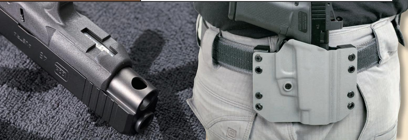
Selbst diese Subkompakt- und Kompaktpistolen besitzen an der Schließfederinne des Griffstücks eine Montageschiene für die Fixierung von Waffenleuchten oder Licht-Laser-Modulen.
