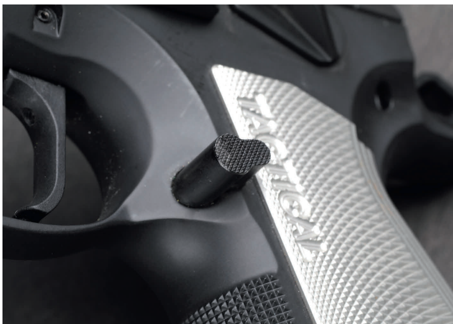
Unter dem Abzugsbügel wurde das Griffstück tief ausgekehlt, der Magazinauslöseknopf steht weit hervor.
