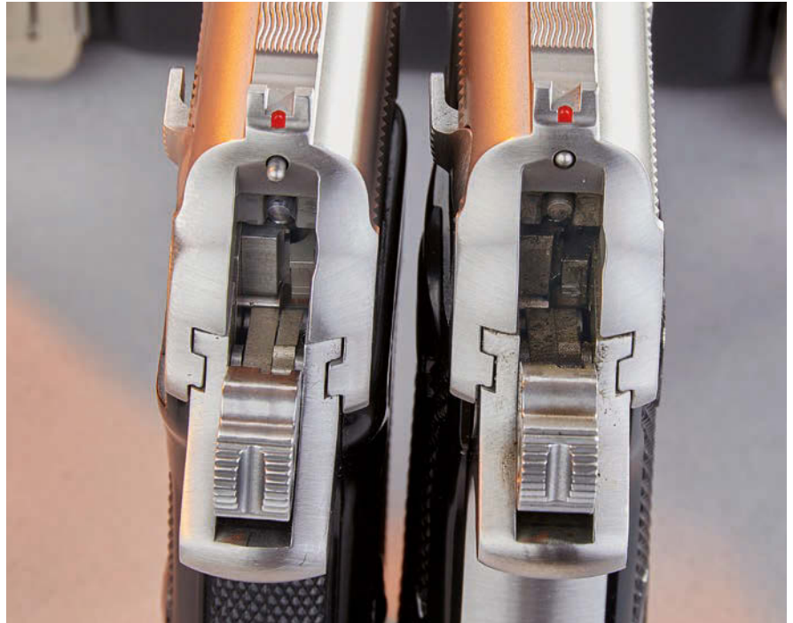
Da geht der Stift! Der Signalstift, links durch eine Hülse in der Kammer aktiviert, ist im Hellen sicht- und im Dunkeln gut fühlbar. Darüber das analoge Rotpunktvisier.
