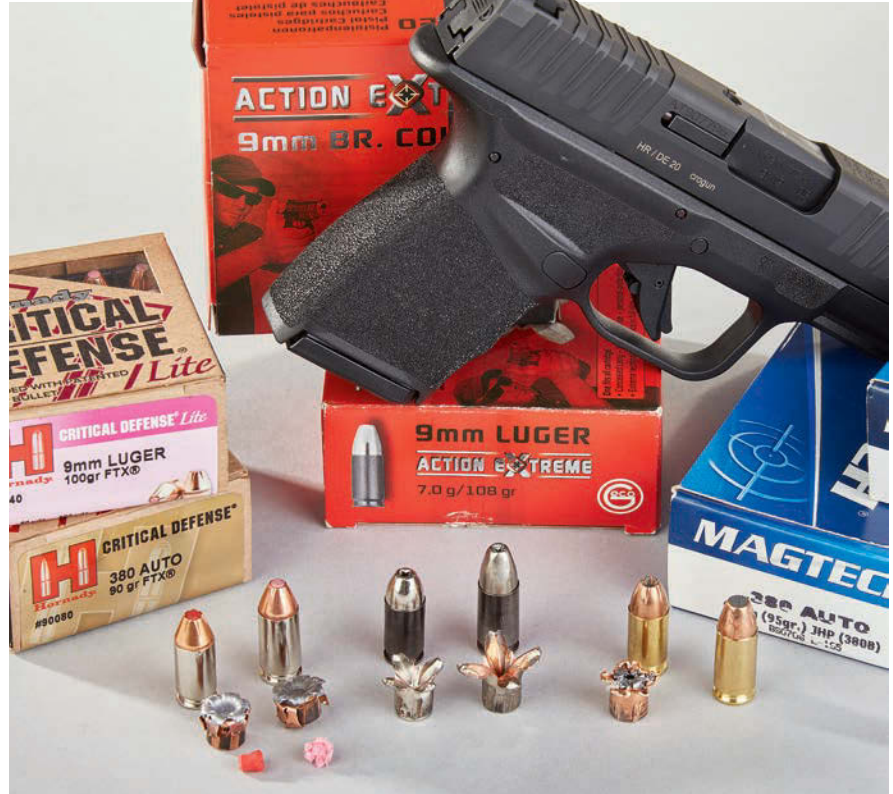
Aus dem Gelatine-Beschuss, von links nach rechts: 90 grs Hornady FTX 9 mm kurz und 100 grs in 9 mm Luger, 85 grs GECO Action Extreme 9 mm kurz und 108 grs 9 mm Luger, 95 grs Magtech JHP, ohne Geschoss davor die durchschlagende 95 grs 9 mm Luger TC.
