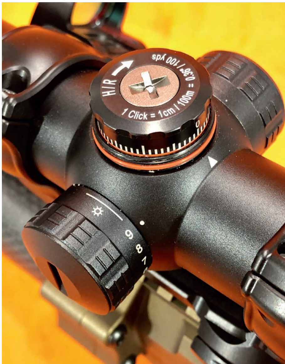
Höhenverstellung des K18i: Gut zu erkennen, die orangenen O-Ringe, mit denen der Turm aufwändig gegen Feuchtigkeit abgedichtet ist. Durch Lösen der großen Schraube oben auf dem Turm kann der Indexring verdreht und somit das Zielfernrohr „genullt“ werden. Links im Bild erkennt man die Einstellskala der Absehenbeleuchtung mit dem „Max Light“-Bereich über der „9“.
