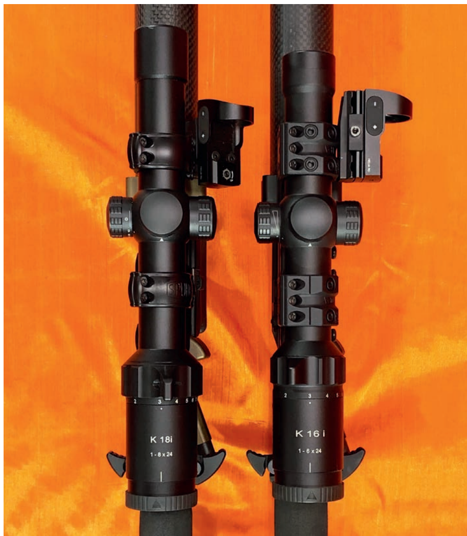
Vogelperspektive: Vergleich des K18i (links) und des K16i (rechts). Beim K16i wurde ein Kahles Helia RD direkt mit Hilfe einer Spuhr Picatinny-Adapter-Schiene an der Spuhr SP-3022 Montage montiert. Beim K18i wurde das gleiche Minileuchtpunktvisier mit DAR RD-Montageschiene an dem DAR Carbon-Handschutz befestigt. Gut zu erkennen, die etwas gewachsene Gesamtlänge des K18i.
