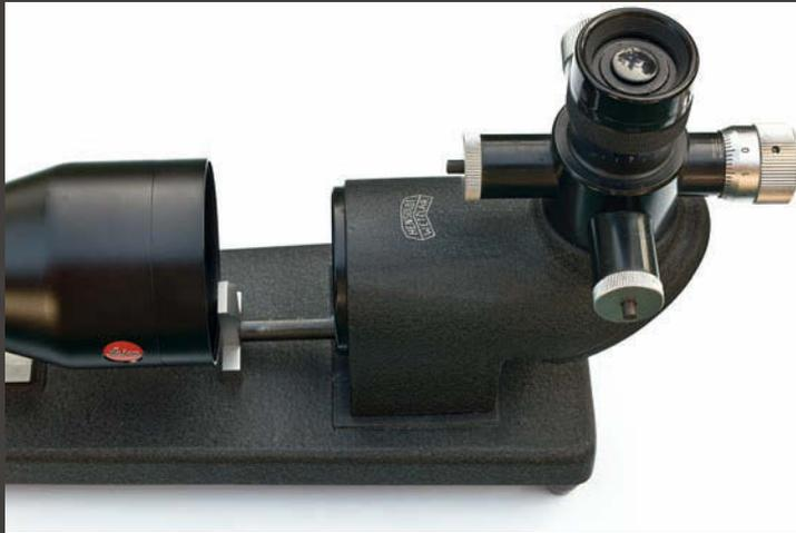
Im ersten Testabschnitt wurde das Leica-Zielfernrohr PRS mittels eines Kollimators überprüft.
