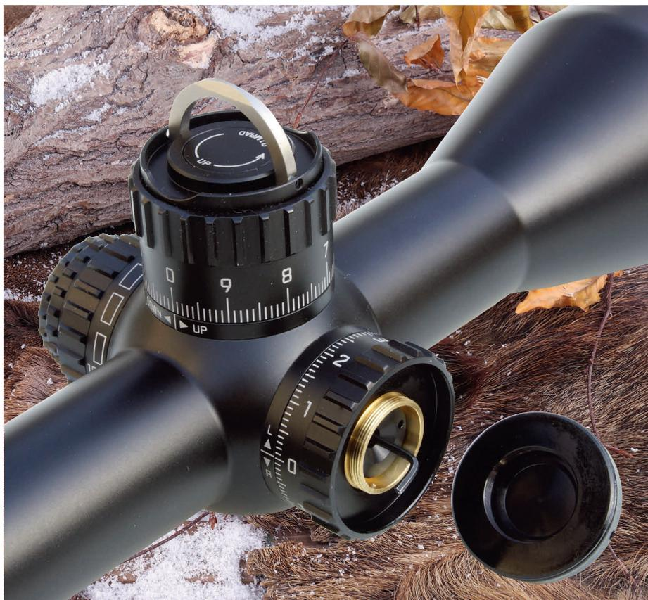
Am Höhenjustierturm sieht man den hochgeklappten Knebel. Damit wird das Rändelrad in der Verzahnung fixiert beziehungsweise gelöst. Bei entfernter Anzugsschraube kann das Rad aus der Verzahnung gezogen werden. Am Seitenverstellungsturm haben wir den Verriegelungsknebel entfernt, wodurch das Bordwerkzeug, ein kleiner 1,5-mm-Inbusschlüssel, sichtbar wird.
