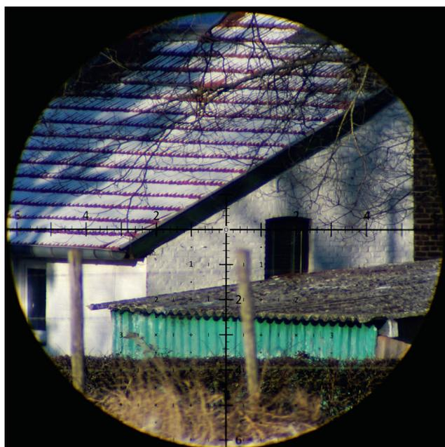
**435 Meter bei 30facher Vergrößerung, jedes Detail ist gut erkennbar aber das Sehfeld beträgt nur 5,5 Meter.**
