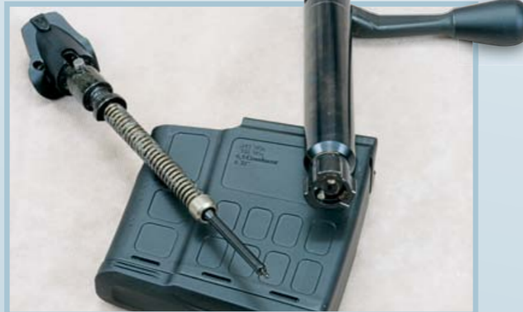
Der typische Mauser 18-Zylinderverschluss mit seinen drei Verriegelungswarzen.
