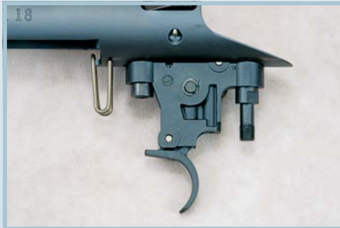
Der simple Flintenabzug mit einem gemessenen Abzugsgewicht von 1.210 Gramm besitzt eine trockene Charakteristik.
