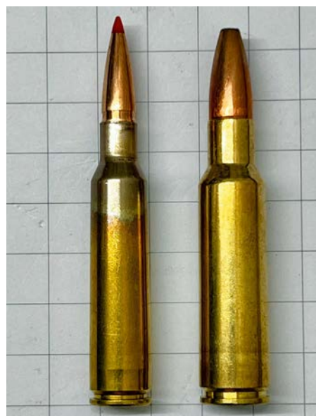
Die 8,5 x 55 Blaser (r.) im Vergleich zur Schwedenmauser-Patrone 6,5 x 55 mm. Beachtlich: das Blaser-Hülsenvolumen.
