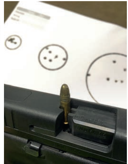
Zu den wenigen Störungen gehörte, dass die Remington Golden Bullet beim Zuführen aus dem Magazin absprang und vom Verschluss gefangen wurde.
