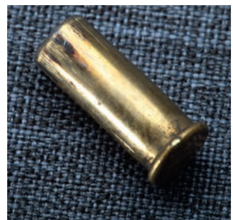
Die Verschmauchungen auf der Hülse zeugen von den Längsrillen, die im Patronenlager vorhanden sind und das Ausziehen der abgefeuerten Hülse erleichtern sollen.
