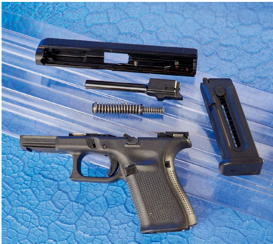
Die G44 in ihren Einzelheiten (v.o.): Verschluss, Lauf, Rückholfeder und Griffstück. Daneben das 10-Schuss-Magazin. Das Zerlegen gestaltet sich wie bei den Großen.
