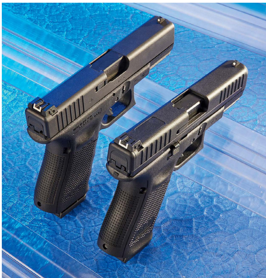
Der Blick ins Auswurffenster verrät das kleine Kaliber: Die großen Glocks verfügen über ein verriegeltes System, die G44 arbeitet mit einem Masseverschluss.
