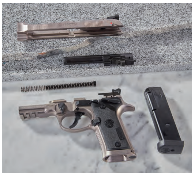
Die 92X zerlegt (von o.): Schlitten, Lauf, Schließfeder mit Führungsstange und Griffstück. Rechts liegt das Magazin.
