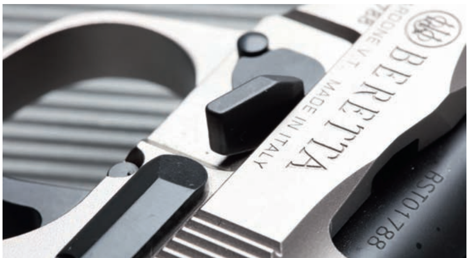
Der Demontagehebel ist weiter ausgestellt und mit einer kleinen Anlagefläche versehen. Er kann dem Daumen der Unterstützungshand als Indexpunkt dienen.
