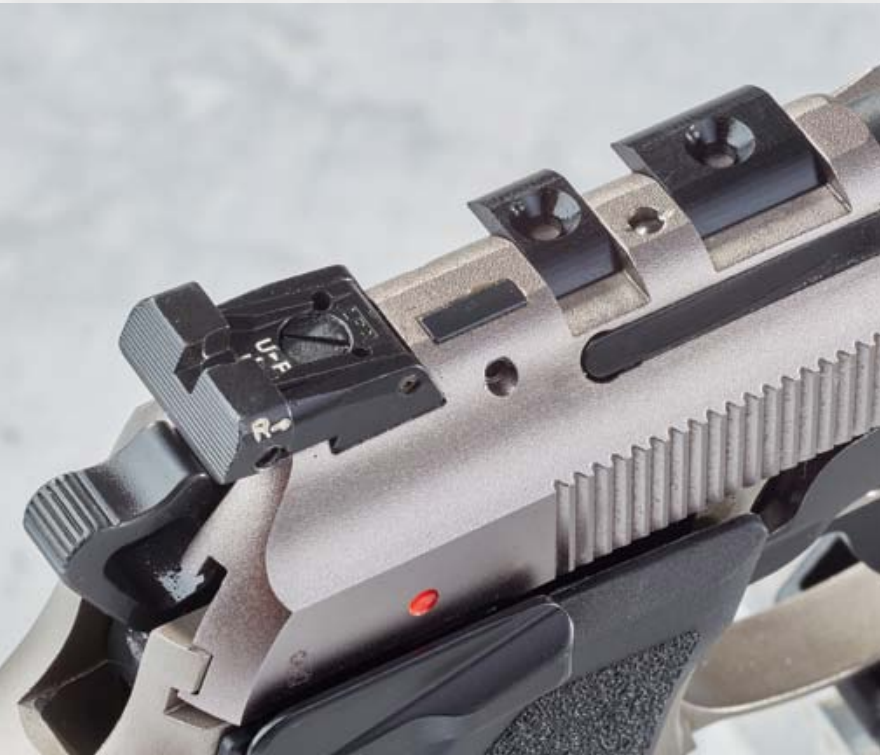
Da wird nicht auf Schraubchen, sondern massive Stege gesetzt, welche den kinetischen Impuls des Rotpunktvisieres nebst Halteplatte aufnehmen.
