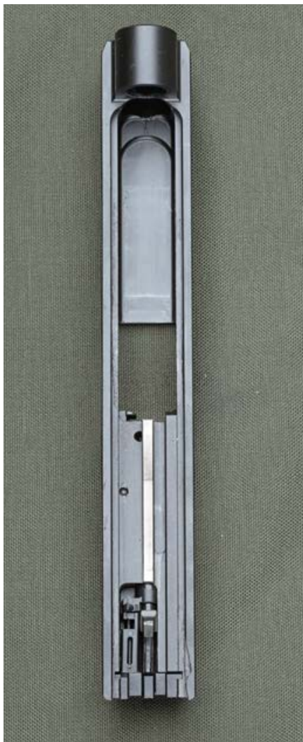
Im Verschluss waren keine groben Verarbeitungsspuren zu finden. Die abzugsgesteuerte Schlagbolzensicherung wird seitlich ausgeschwenkt.
