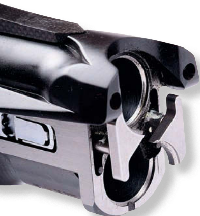
Durch den geteilten Auszieher wird jeweils nur die abgefeuerte Hülse durch den jeweiligen Ejektor ausgeworfen.
