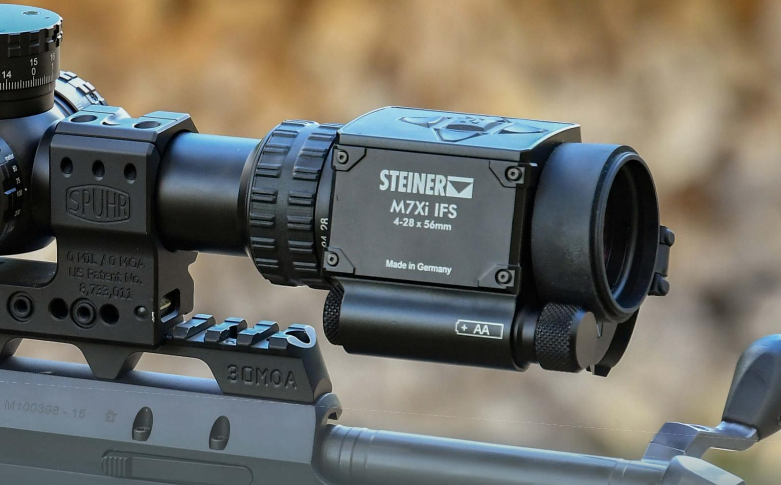
Vergrößerungsbereich von 4 – 28-fach. Das Zielfernrohr kann dabei mit einem G2B- oder aber einem MSR-2-Absehen ausgerüstet werden. Das G2B stellt eine Abwandlung des klassischen MIL-DOT-Absehens dar und verfügt zusätzlich über Teilstriche zwischen den DOTs. Das MSR-2 Absehen gehört ebenfalls zu den taktischen Absehen mit einer MIL-Einteilung und verfügt zusätzlich über Größen- und Distanzindikatoren, um die Entfernung zum Ziel berechnen zu kön-
