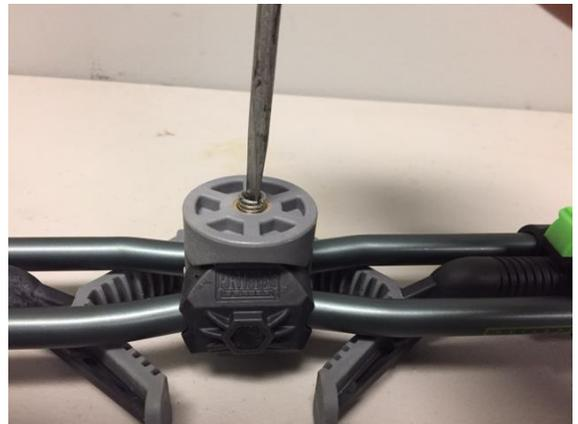
4. Befestigen Sie nun den Camera-Optic-Mount an der Gewehrauflage.
