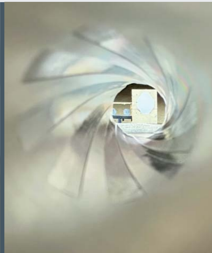
Blick durch den Lauf bei eingeschraubtem „Ampliator“-Choke mit Feld/Zug-Profil.
