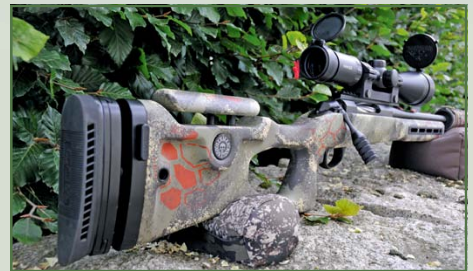
Der German Gun Stock Daumenlochschaft aus kreuzlaminieren, in Epoxidharz getränkten Birkenholzschnitten mit verstellbarer Schaftkappe und Wangenauflage.
