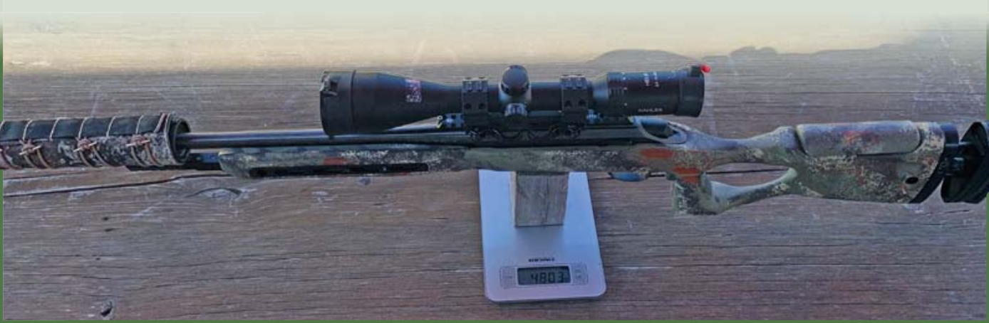
Der Schaft bringt 1.633g auf die Waage und ist am Pistolengriff perfekt austariert. Die Komplettwaffe mit Optik und Schalldämpfer wiegt 4.800 Gramm.
