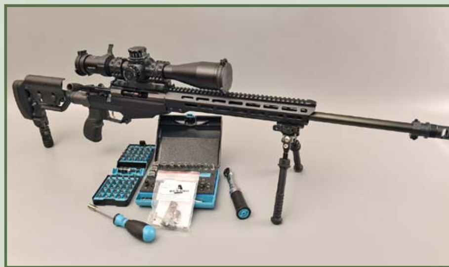
Matchkönig: Diese Tikka T3x TACT A1 in 6,5 Creedmoor wurde von uns mit einem erstklassigen Kugelabzug von „Bix'n Andy“ ausgerüstet.
