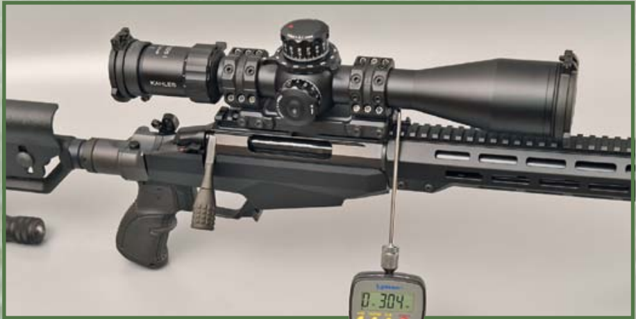
Federleicht: Der Kugelabzug besitzt ein wiederholgenaues Abzugsgewicht von lediglich 300 Gramm!
