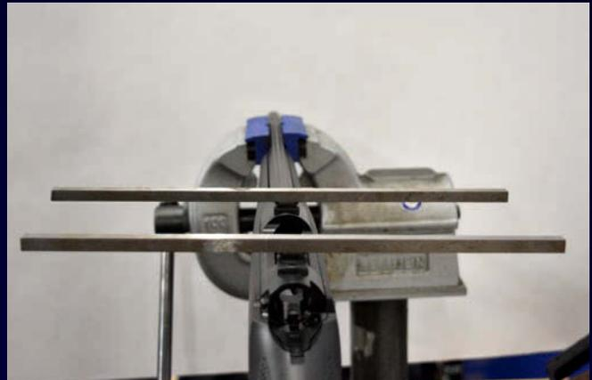
Sitzt alles schön gerade? Die Ausrichtung der Montagebasen und später der Ringe und des Zielfernrohrs prüfen.
