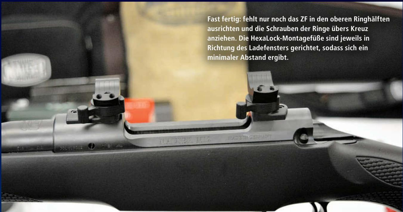
Fast fertig: fehlt nur noch das ZF in den oberen Ringhälften ausrichten und die Schrauben der Ringe übers Kreuz anziehen. Die HexaLock-Montagefüße sind jeweils in Richtung des Ladefensters gerichtet, sodass sich ein minimaler Abstand ergibt.
