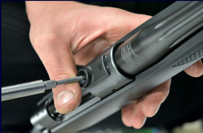
Montagebasen mittels Loctite 603/648 verkleben, dann ihre Schrauben mit 5 Nm anziehen.
