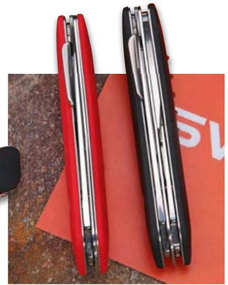
Der Blick auf den Bauch des Messergriffs zeigt den Aufbau mit Stahlplatinen; links neben der Klinge und oben im Griff sieht man die Kante des Pfriems.
