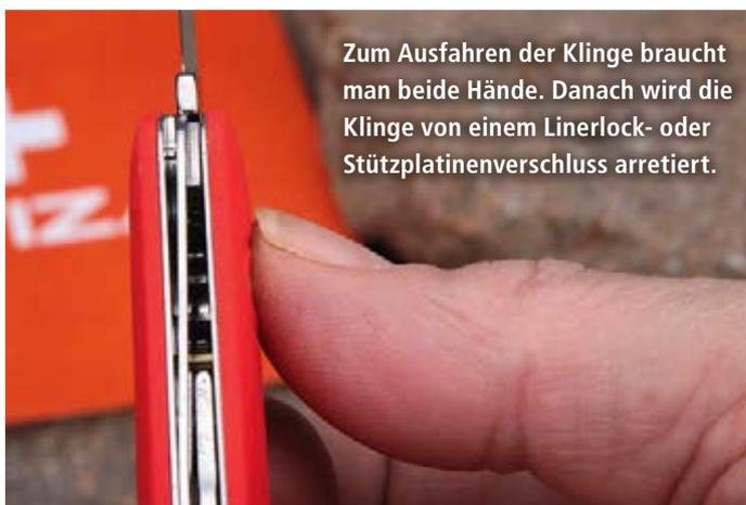
Zum Ausfahren der Klinge braucht man beide Hände. Danach wird die Klinge von einem Linerlock- oder Stützplatinenverschluss arretiert.
