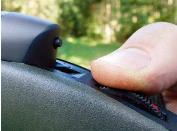
Das Rädchen fungiert als Sicherung. Komplett nach hinten gezogen wird auch der Schlagbolzen blockiert.
