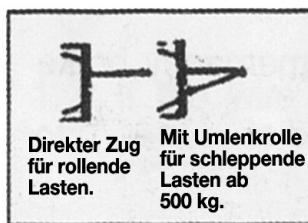
Bei Lasten über 500 kg empfehlen wir die Benutzung einer Umlenkrolle.
